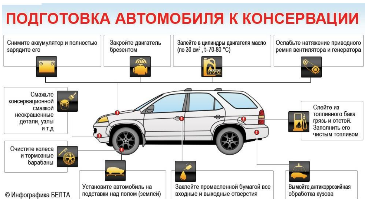
Рис. 3. Схема подготовки автомобиля к консервации
