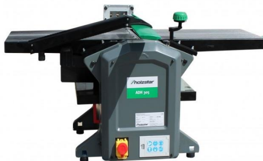
Рис. 2. Фуговально-рейсмусовый станок «Holzstar» ADH-305
