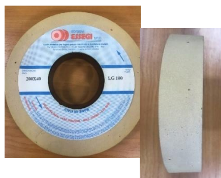
Рис. 3. Шлифовальный круг на основе пенополиуретана
