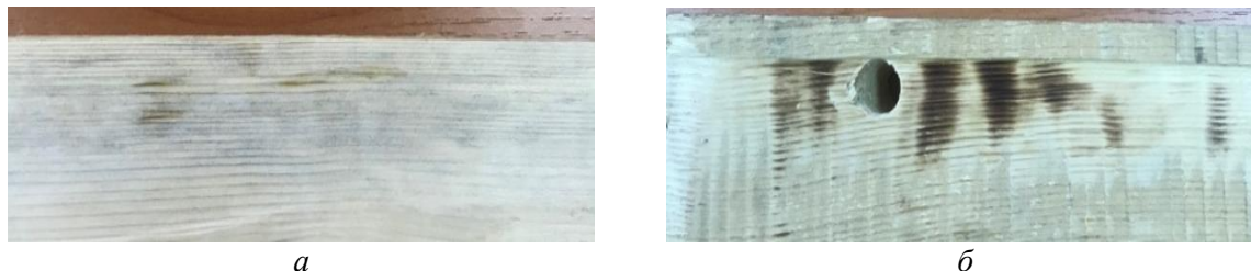
Рис. 5. Поверхность древесины осины с прижогом после обработки шлифовальным кругом на основе: а – ППУ (Россия); б – ESSEGI (Италия)
