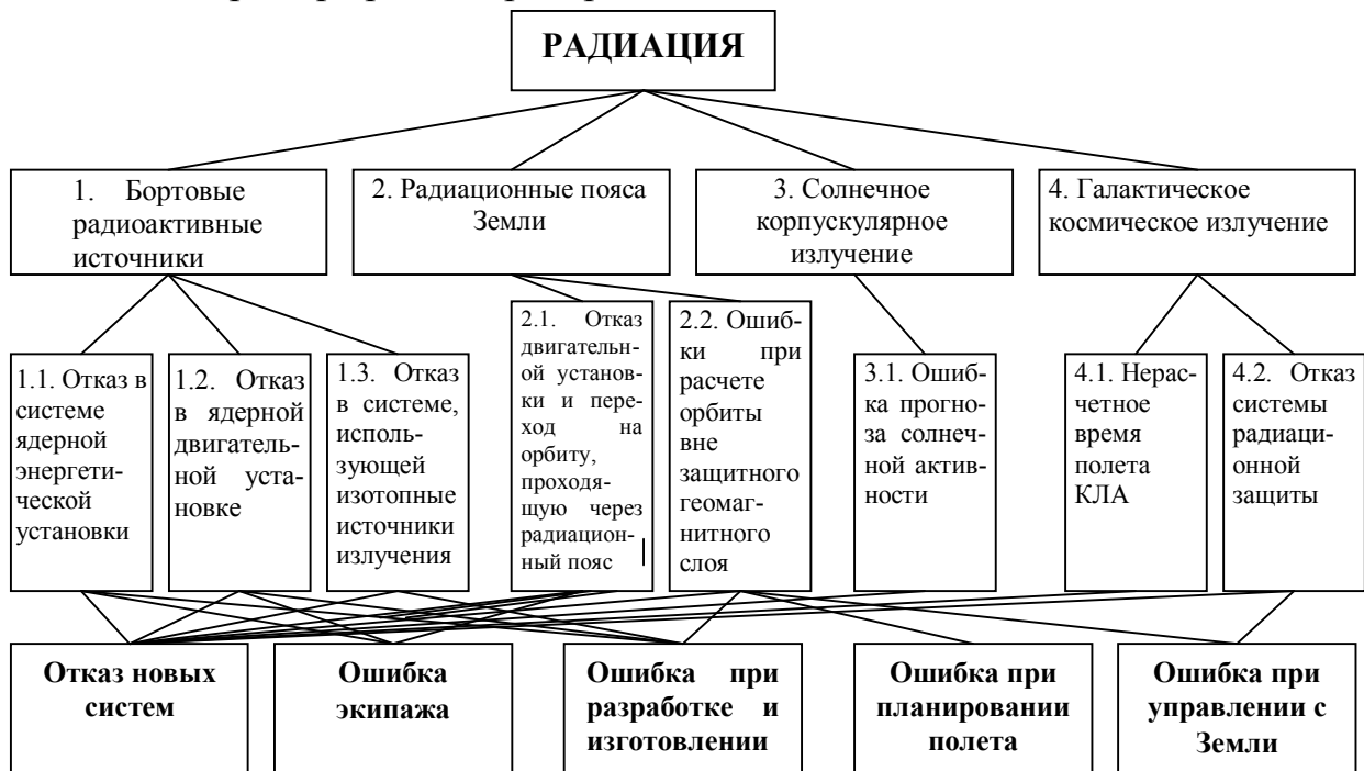
Рис. 1. Дерево событий, обусловленных разными аспектами опасного воздействия радиации на КЛА (космический летательный аппарат)
