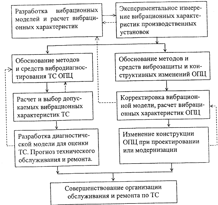
Рис. 1. Схема вибродиагностирования и виброзащиты варочного ОПЦ: — — — — — прямая связь; - - - - - обратная связь
