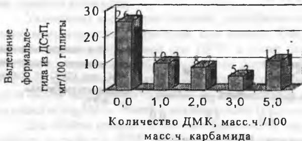
Рис. 3.5. Зависимость выделения формальдегида из ДСтП от количества диметилкарбамида в составе КФС.
