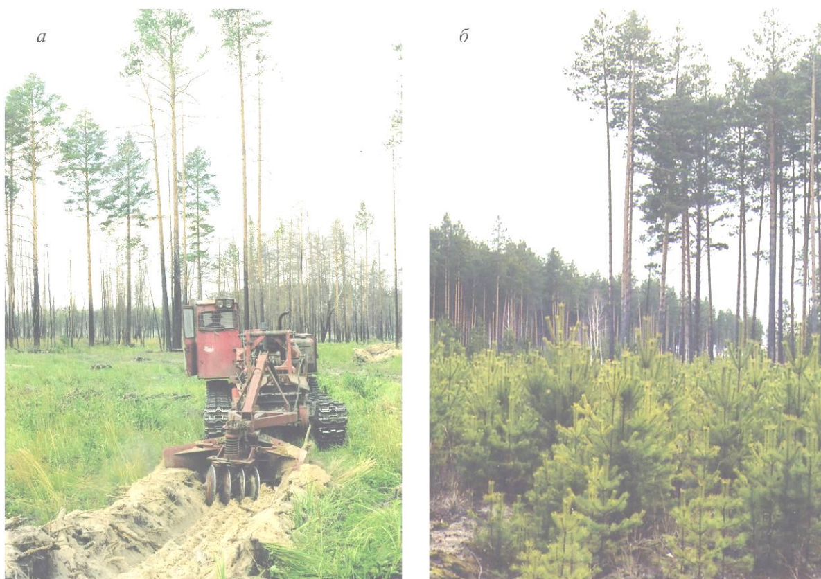
Рис. 6. Агрегат для подготовки оптимального субстрата (минерализация с рыхлением поверхности почвы) под самосев сосны (а) и отличное естественное возобновление сосны (23 тыс. экз./га) от семенных куртин в результате его применения (б) на вырубке в сосняке бруснично-чернично-зеленомошном в квартале 133 бывшего Южного лесничества Тугулымского лесхоза (Санников и др., 2002).
