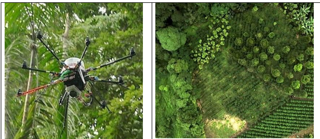
Рис. 7. Паукообразный беспилотный вертолет (автокоптер) в полете на Острове Барро Колорадо (Панама) в июне 2013 года, Смитсоновский институт тропических исследований (слева) и его снимок растительного покрова в Коста Рике (справа) ( http://www.scientificamerican.com/article.cfm?id=camera-equipped-autocopters-map-forest-treetops )
