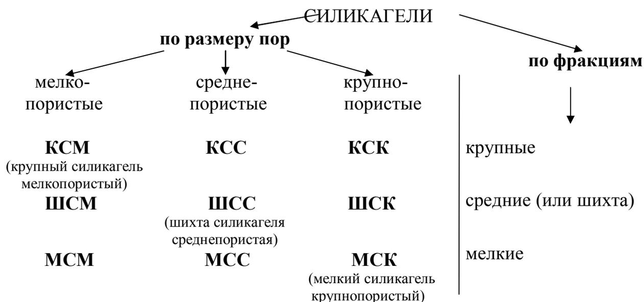
Рис. 1. Классификация силикагелей, где первая буква обозначает размер фракции (крупные, шихта, мелкие); вторая – тип адсорбента (силикагель); третья – размер пор (крупно-, средне-, мелкопористые)
