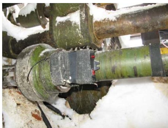
Рисунок 14 – Распиливаемый двукантный брус и установленный акселерометр на синхронизирующем валу механизма резания ЛРВ - 2
