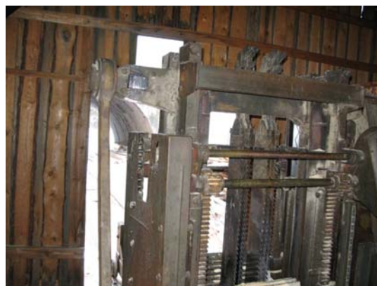
Рисунок 10 – (слева на право) Лесопильная рама ЛРВ 1 и закрепленный акселерометр
