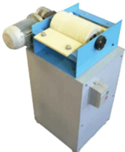
Рис. 1. Клеенаносящая машина «КМ-250»
