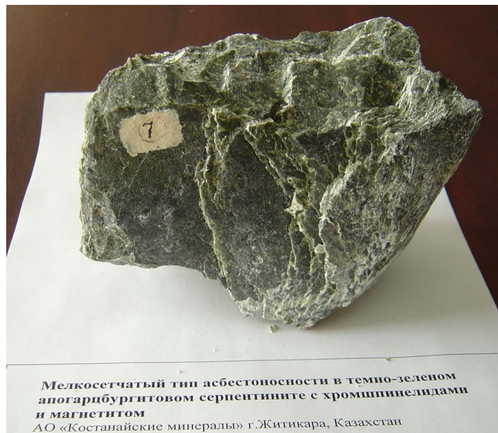
Рис. 3. Мелкосетчатый тип асбестоносности в темно-зеленом апоргарцбургитовом серпентините с хромшпинелидами и магнетитом
