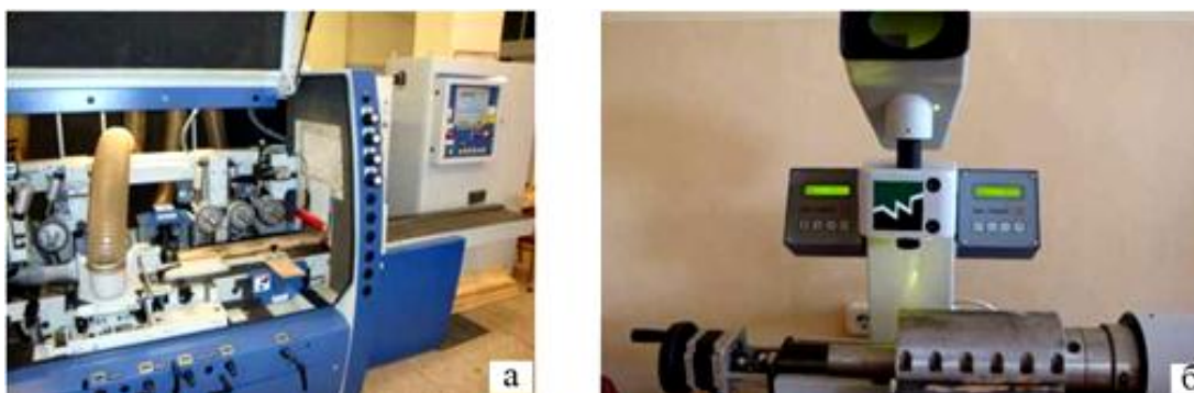
Рис. 4. Используемые установки: a – Unimat 23EL; б – OptiControl
