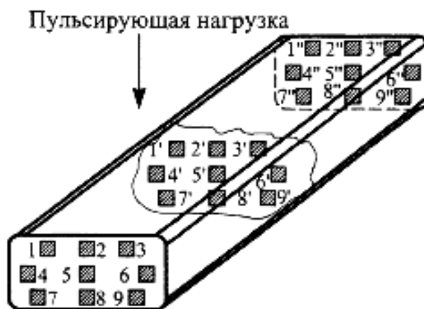
Рис. 1. Схема выпиловки образцов из шпалы для динамических испытаний
