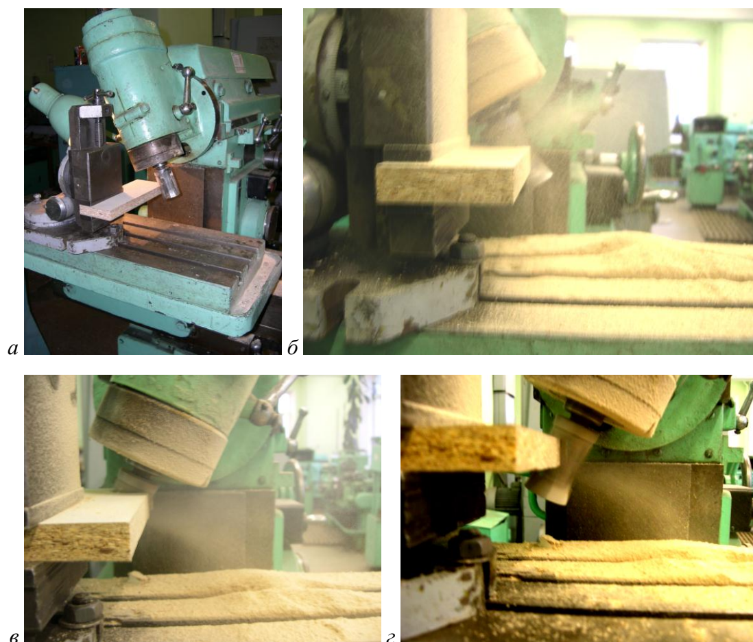
Рис. 3. Вертикально-фрезерный станок ( а ) и его применение для обработки заготовки ДСтП пустотелой фрезой, ось которой наклонена в направлении подачи (неполное фрезерование ( б )), фрезой, ось которой наклонена в направлении, противоположном направлению подачи (полное фрезерование ( в ), неполное фрезерование ( г ))
