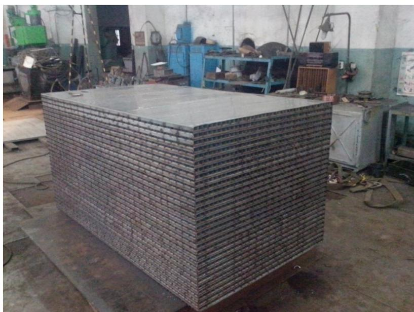
Рис. 2. Модуль теплообменника, собранный из газовых и воздушных панелей
