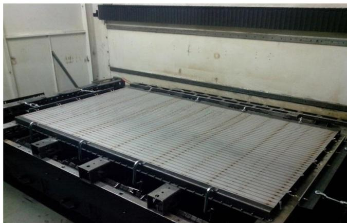
Рис. 3. Готовая «газовая» панель на оснастке
