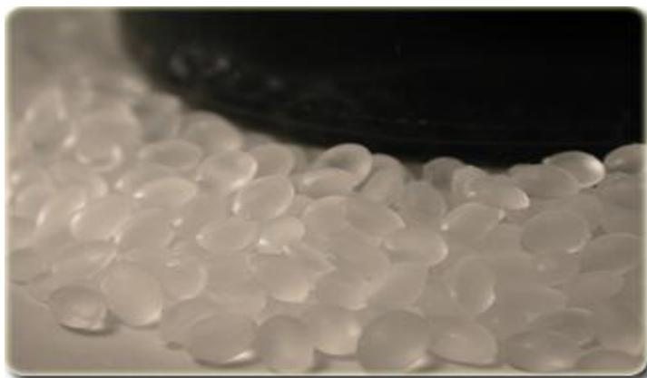
Полимер «Элвалой»: внешний вид (гранулы размером 3–5 мм)
