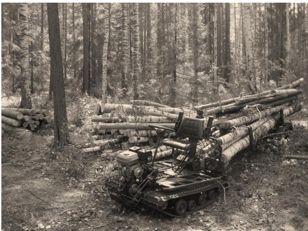
Рис. 1. Опытный образец мини-трактора МТР - 1
