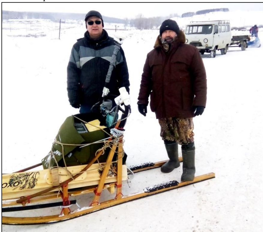
Рис. 6. Немагнитные нарты и утепленный приборный отсек.
