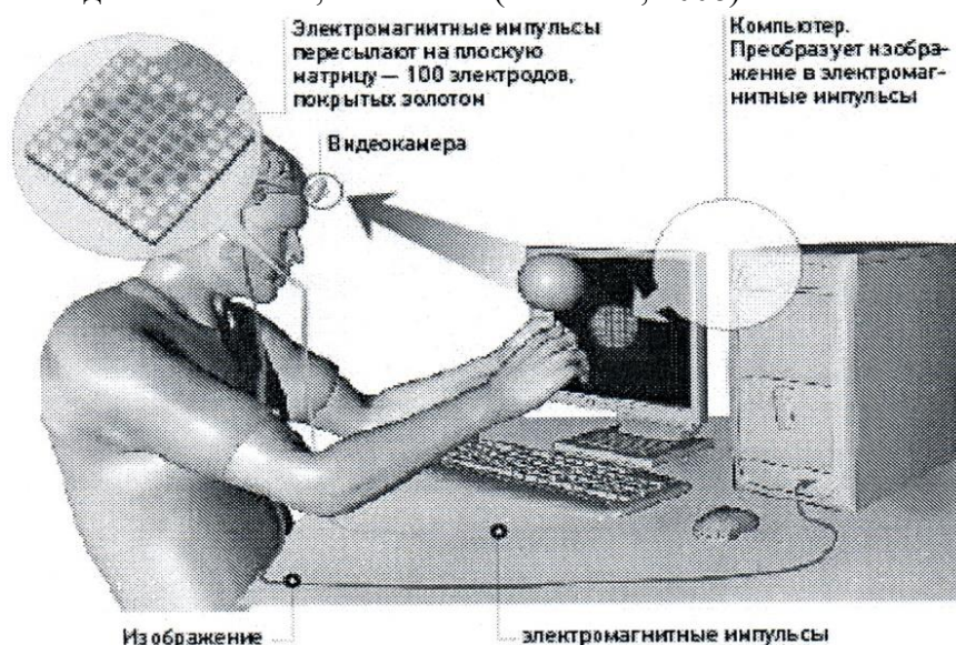
Рис. 2. Схема системы тактильно-визуального замещения (Батенева, 2008)
