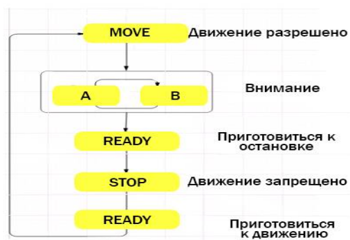
Рис. 3. Структура логики работы модели светофора
