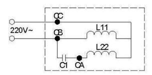
Рис. 1. 1-фазный двигатель
