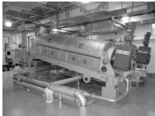
а б Рис. 5. Короотжимной пресс: схема (а) и фотография (б)
