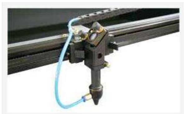
Рис. 7. Лазерная головка, перемещаемая системой ЧПУ
