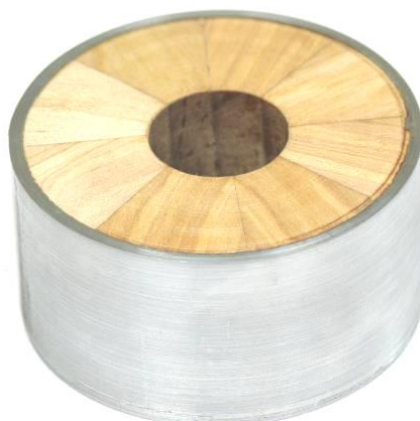
Рис. 2. Фотография древесно-металлического подвешного подшипника для шнекового конвейера ДКВ-200
