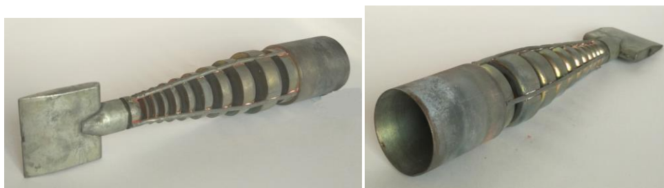
Рис. 3. Вид жалюзийной решетки пылеотделителя экспериментальной установки
