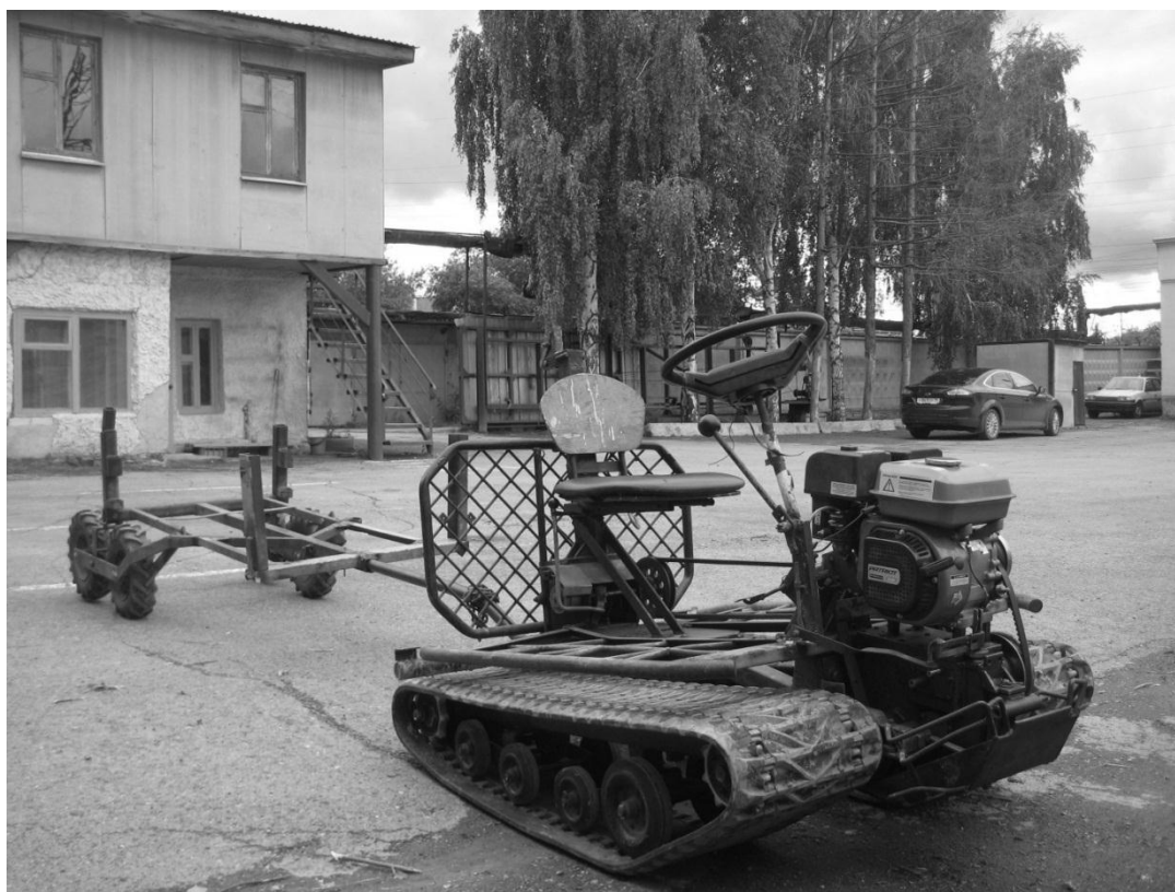
Рис. 1. Мини-форвардер с прицепным устройством
