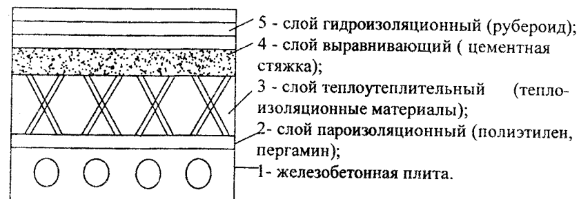
Рис. 2. Сбор нагрузок перекрытия
