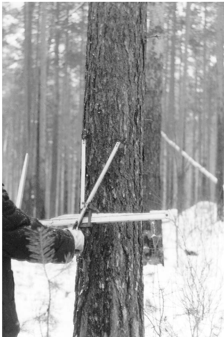
Рис. 27. Разметка карр вилкой-разметчиком КарНИИЛП
