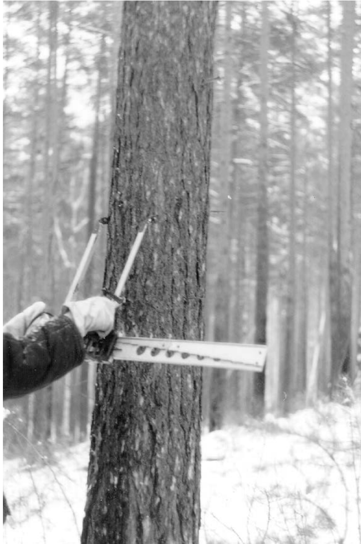
Рис. 29. Разметка карр разметчиком 1РА
