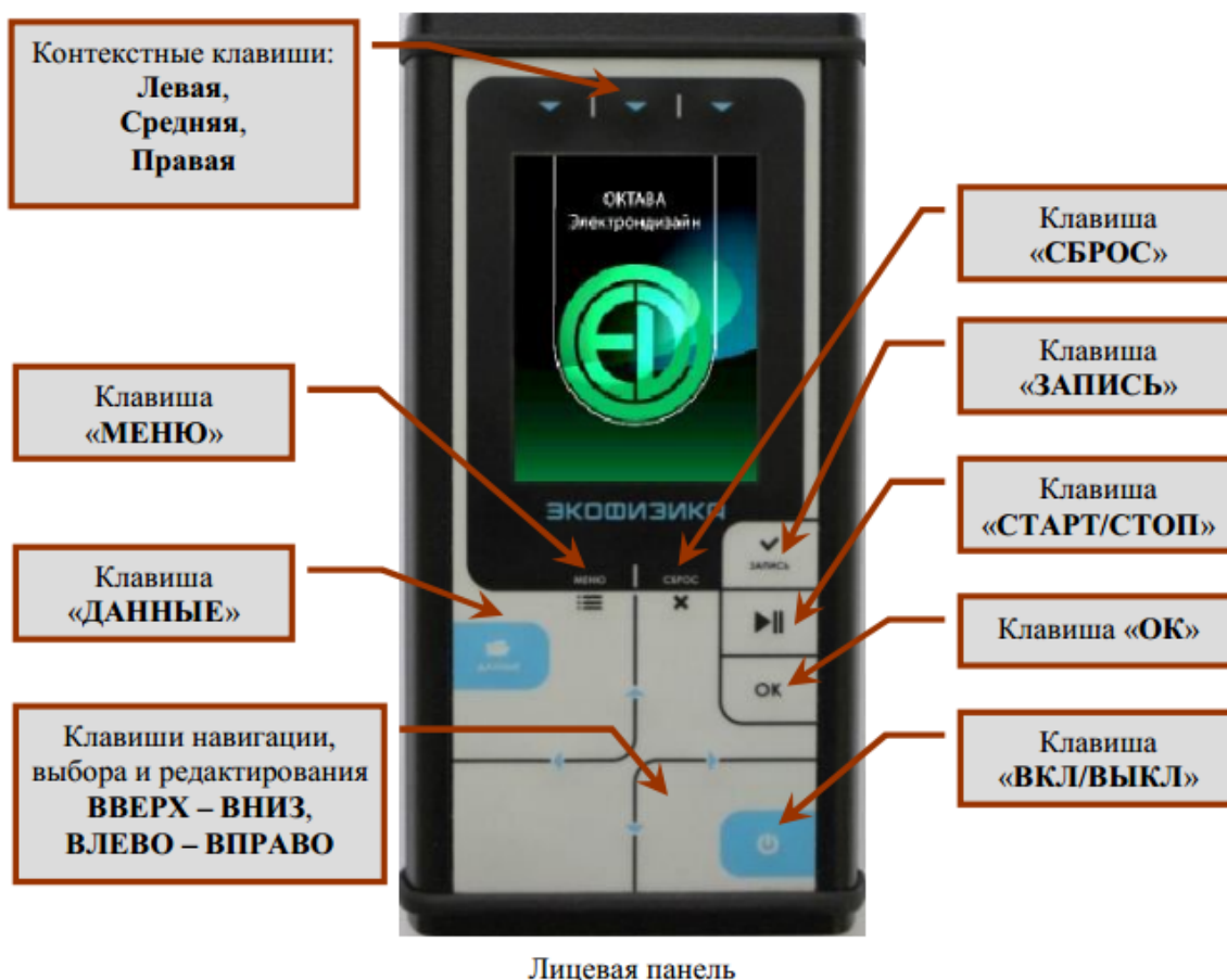
Рис. 3.2. Внешний вид прибора ЭКОФИЗИКА-110А и описание клавиш
