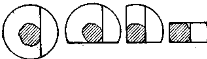
Рис. 25. Схема кругового способа распиловки сырья
