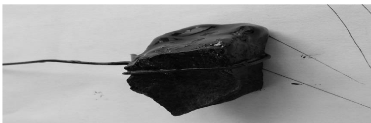
Рис. 2. Известняковый щебень с добавкой «НИТОН марка Д1» после испытаний
