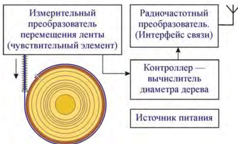
Рис. 2. Структурная схема измерителя диаметра дерева по обхвату
