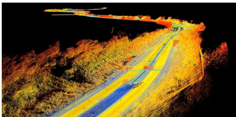
Рис. 2. Пример результата съемки автомобильной дороги лазерным сканером
