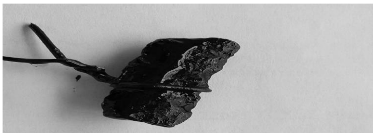
Рис. 1. Гранитный щебень с добавкой «НИТОН марка Д1» после испытаний
