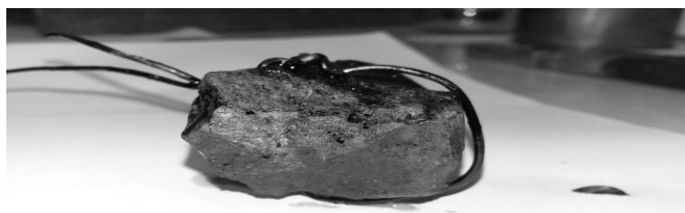
Рис. 4. Известняковый щебень, покрытый битумом без добавки
