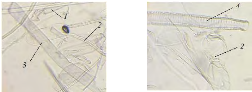
Анатомические элементы технической целлюлозы из борщевика: 1 – длинная паренхимная клетка; 2 – бочковидная паренхимная клетка; 3 – членик пористого сосуда; 4 – сосуд со спиральным утолщением
