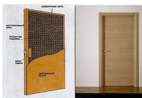
Рис. 1. Конструкция щитового дверного блока
