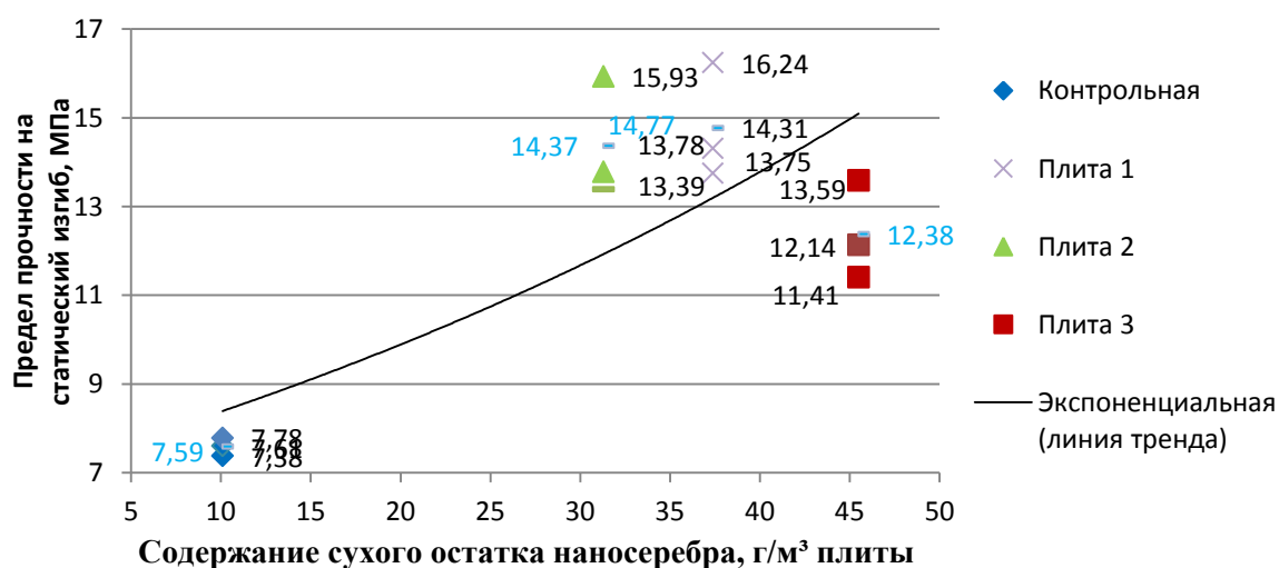
Рис. 2. Зависимость предела прочности на изгиб от количества наносеребра (исследования 2019 года)
