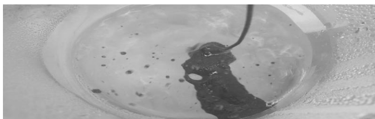
Рис. 3. Гранитный щебень, покрытый битумом без добавки
