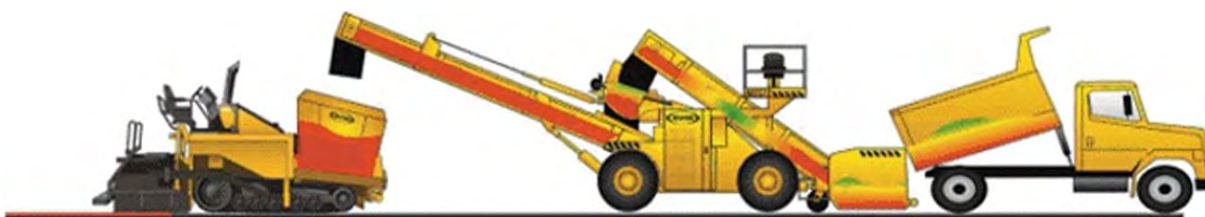
Рис. 2. Технологическая схема непрерывной укладки асфальтобетонной смеси с применением самоходного перегружателя
