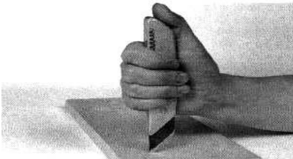
Рис.10. Захват ножа-косяка при резьбе на себя (способ 1)
