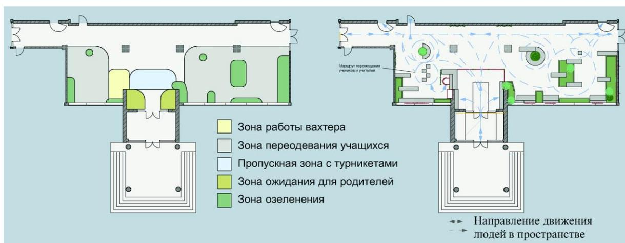
Рис. 2. Схема зонирования холла
