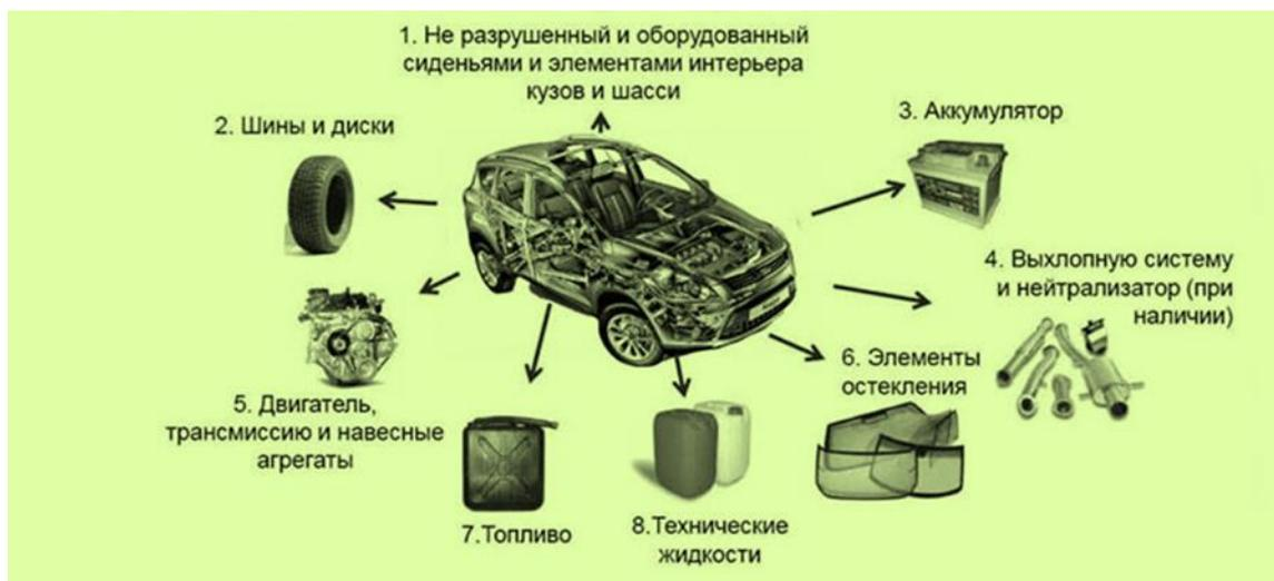
Комплектация утилизируемого автомобиля
