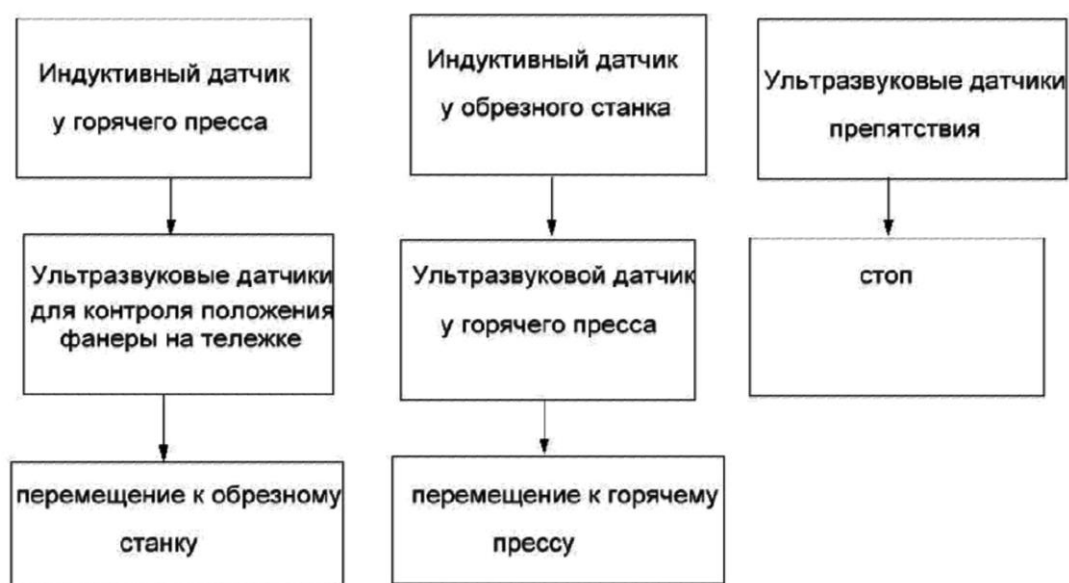
Структурная схема системы автоматизации тележки
