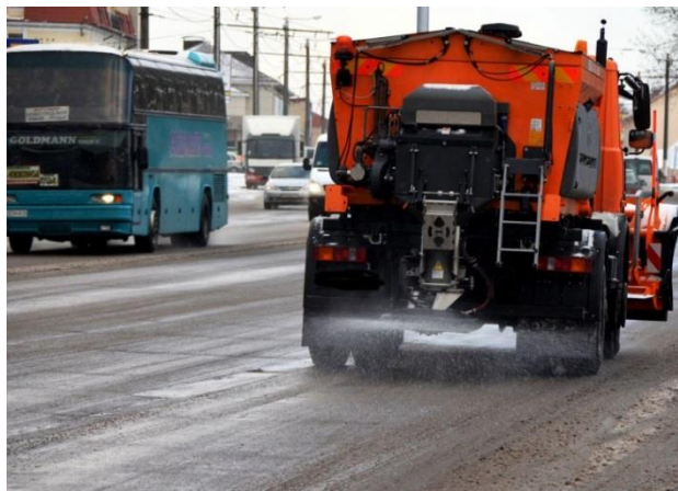
Распределение противогололедных реагентов на проезжую часть автомобильной дороги
