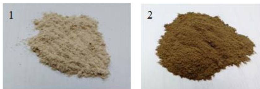
Рис. 1. Древесная мука: 1 – высушенная при 130 °С; 2 – термически модифицированная при 200 °С
