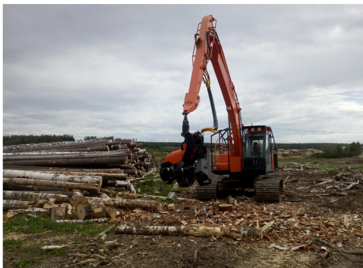
Рис. 4. Раскряжевка хлыстов мультифункциональной машиной на верхнем складе
