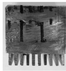
Рисунок 7 – Примеры пуансонов для формирования проушин: а – одинарной, B = 12 мм, h_n = 30 мм; б – многократных, B = 4 мм, h_n = 20 мм; в – многократных, B = 2 мм, h_n = 10 мм
