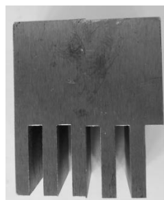
Рисунок 7 – Примеры пуансонов для формирования проушин: а – одинарной, B = 12 мм, h_n = 30 мм; б – многократных, B = 4 мм, h_n = 20 мм; в – многократных, B = 2 мм, h_n = 10 мм
