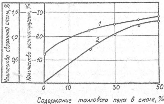
Рис. 3. Влияние таллового пек на образование прочного соединения с карбамидоформальдегидной смолой:
