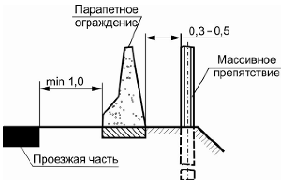
Рис. 4.5. Расположение недеформируемого дорожного ограждения возле массивного препятствия
