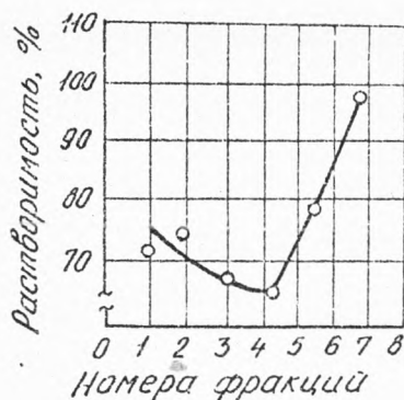
Рис. 1. Зависимость растворимости термообработанных лигносульфонатов алюминия от фракционного состава
