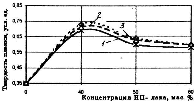
Рис. 2. Зависимость времени отверждения (а) и твердости лаковой пленки (б) от концентрации НЦ-лака в композиции: 1, 2, 3 – соответственно 40, 50, 60% нелетучих веществ в пентафталевом лаке
