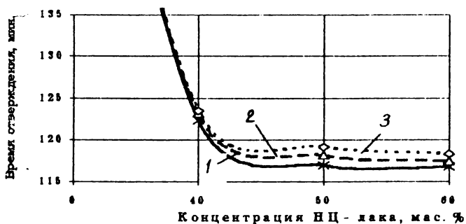
Рис. 1. Зависимость жизнеспособности композиции от концентрации НЦ-лака: 1, 2, 3 – соответственно 40, 50, 60% нелетучих веществ в пентафталевом лаке
