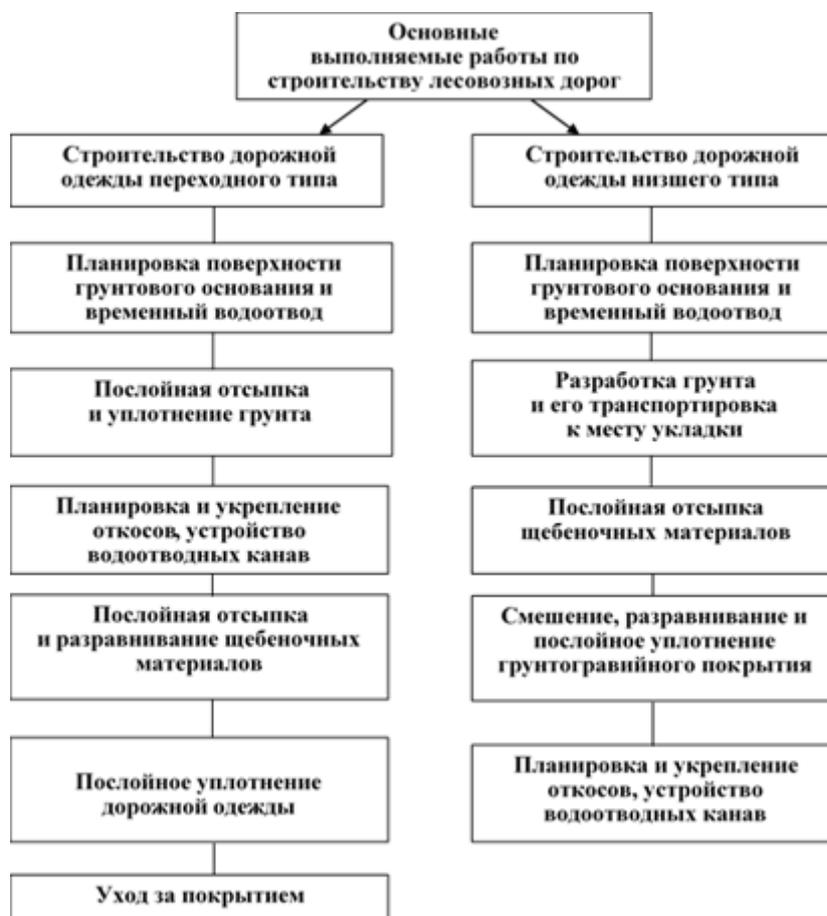
Рисунок 10 – Последовательность работ при строительстве лесовозных дорог
