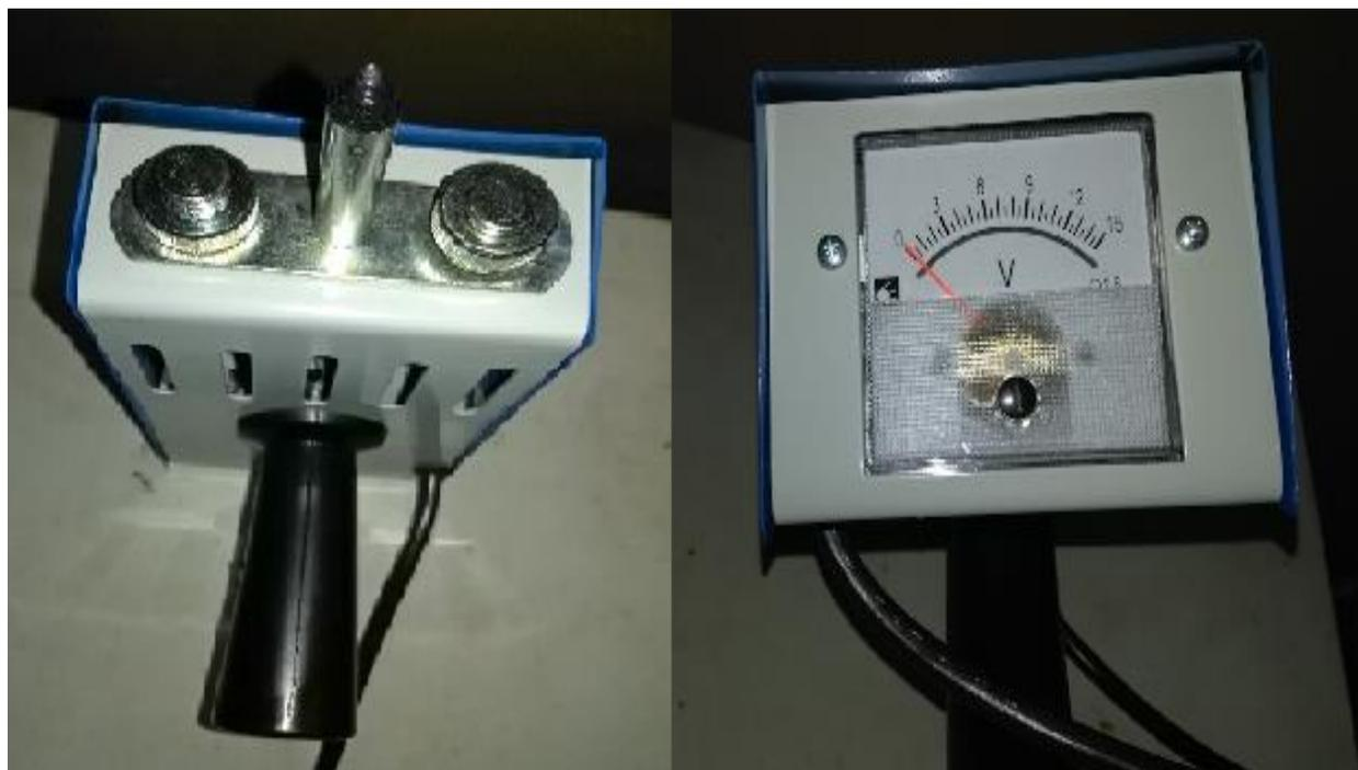
Рис. 3. Внешний вид нагрузочной вилки НВ-02
