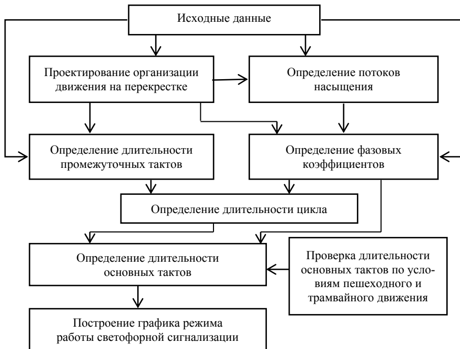
Рис. 17. Последовательность расчета длительности цикла и его элементов
