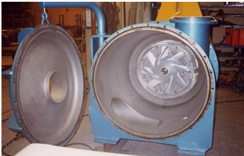
Рис. 3. Вертикальный гидроразбиватель закрытого типа с дисковым ротором
