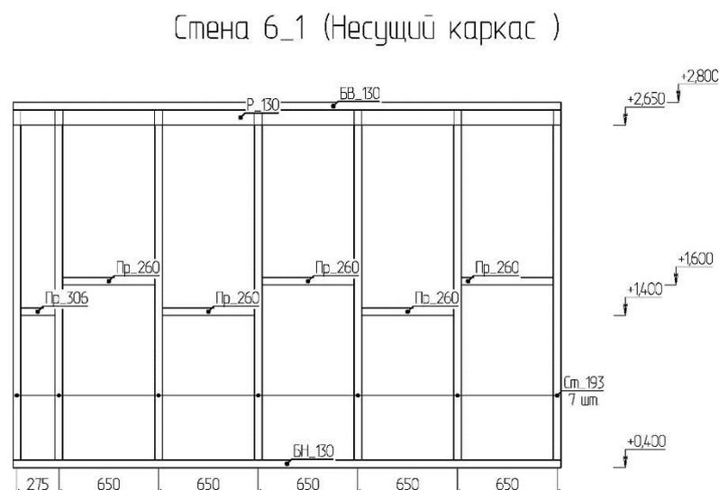
Рис. 4. Создание развертки стены в осях 6-1
