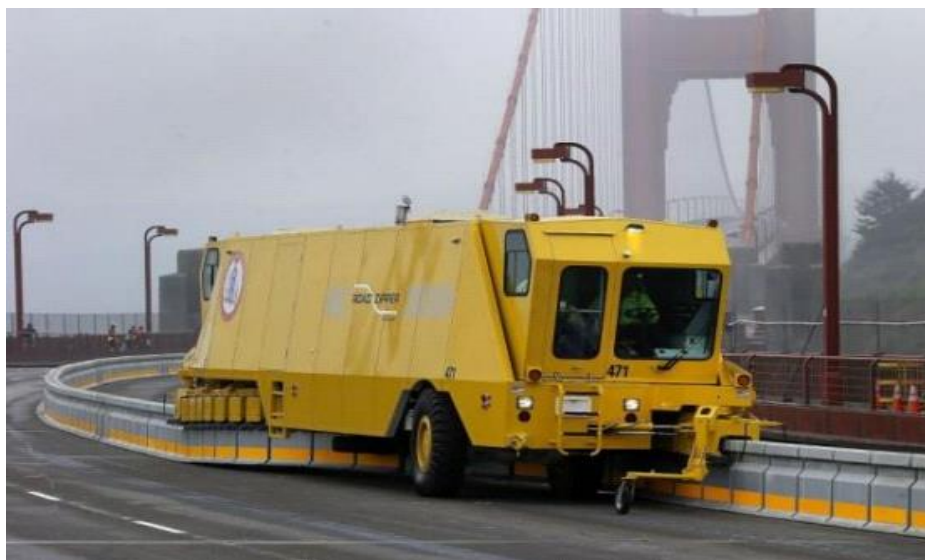
Рис. 3. Организация передвижных дорожных ограждений парапетного типа
