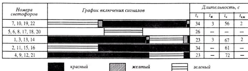
Рис. 3.8. Режим работы светофорной сигнализации, обеспечивающий пофазный разезд транспортных средств
