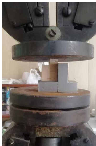
Рис. 3. Образец, закрепленный в специальном приспособлении под нагрузкой испытательной машины
