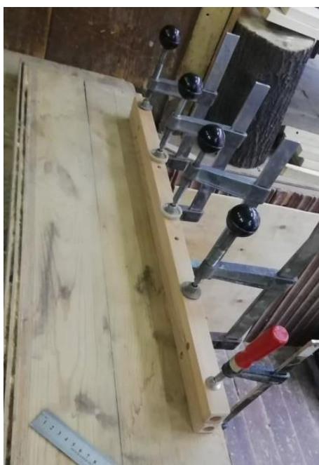
Рис. 1. Процесс склеивания ламелей бука
