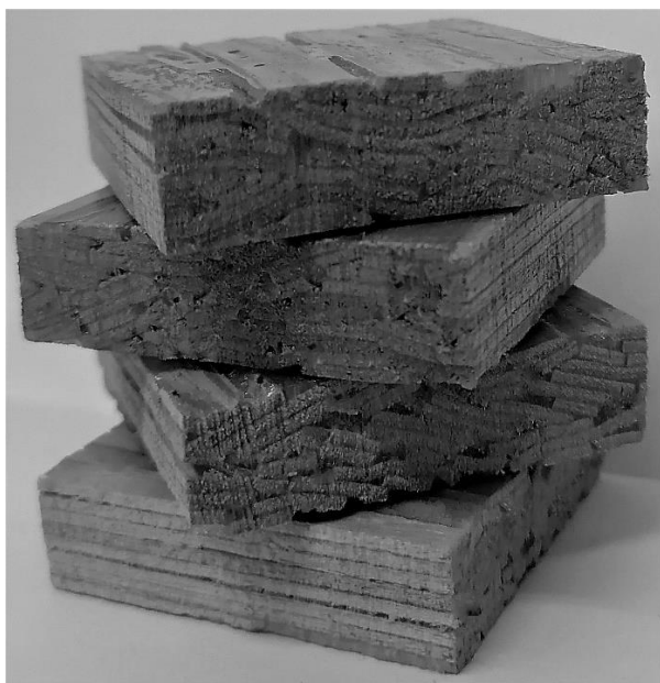
Образцы PSL2 на эпоксисоволачном связующем с карданолсодержащим основанием Манниха
