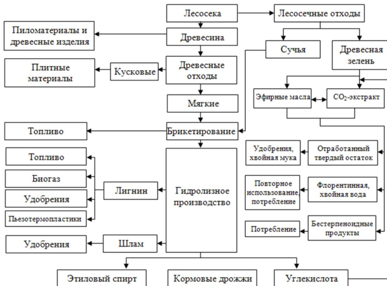
Рис. 3. Схема переработки мягких древесных отходов
