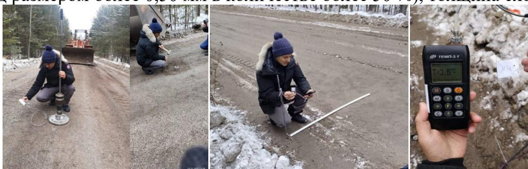
а) динамическим плотномером ZFG-3000-10 GPS; б) методом режущего кольца; в) установка термопары XK (L); г) измерение температуры грунтовермикулитового слоя Термп-3.11
