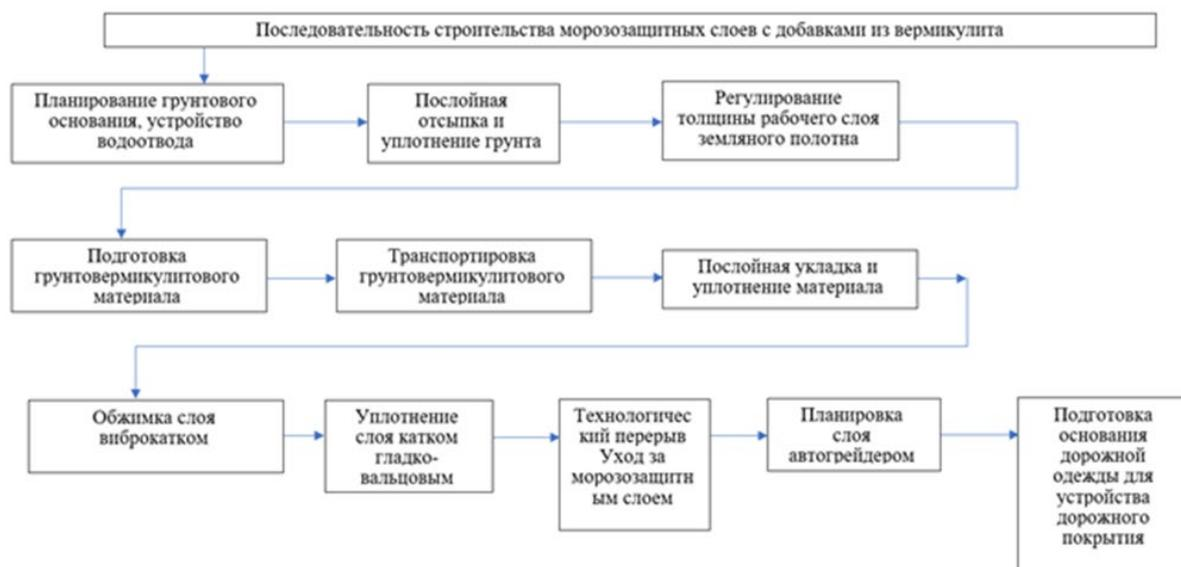
Рисунок 10 – Последовательность работ при строительстве конструктивного морозозащитного слоя с добавками из вермикулита
