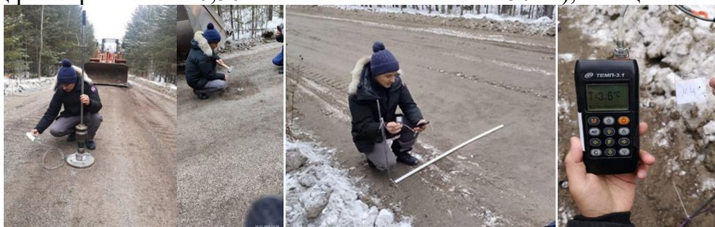
а) динамическим плотномером ZFG-3000-10 GPS; б) методом режущего кольца; в) установка термопары ХК (L); г) измерение температуры грунтовермикулитового слоя Темп-3.11
