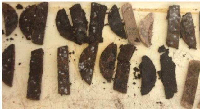
Рис. 2.17. Внешний вид образцов ПБС (на основе древесных опилок, шелухи пшеницы и проса) после 21 сут экспозиции в активном грунте
