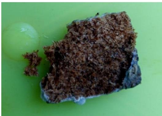
Рис. 2.18. Фрагмент ПБС (на основе древесных опилок) с признаками расслоения, разбухания, краевой и продольной фрагментации
